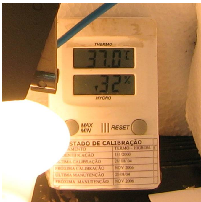
Figura 6 – Termômetro digital utilizado para a realização dos ensaios a temperatura que simulasse a bucal (37°C).
