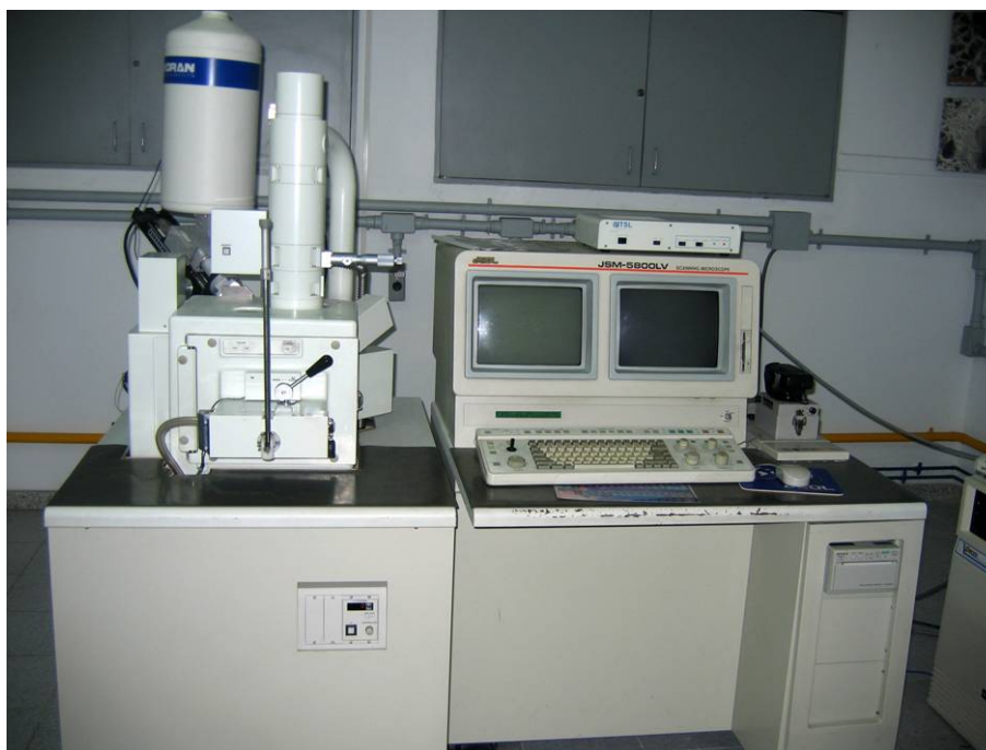
Figura 7 – Microscópio eletrônico utilizado para obtenção de imagens da superfície dos fios.
