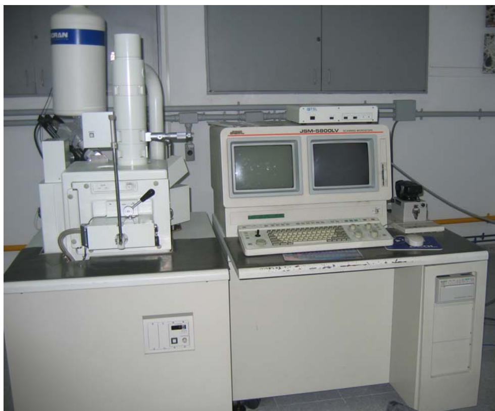
Figura 10 – Microscópio Eletrônico de Varredura (J SM – 5800 LV Scanning microscope – JEOL ®) do Instituto Militar de Engenharia – IME.
