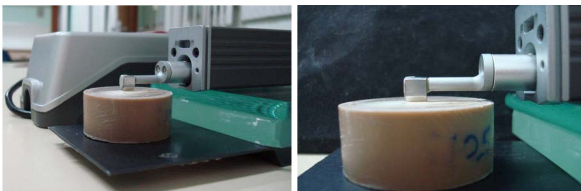
Figura 9 – A) Rugosímetro (Mitutoyo SJ-201P) do Laboratório de Ensaaios Mecânicos (UERJ) com o sensor posicionado sobre o corpo de prova. B) Vista aproximada do posicionamento do sensor em relação ao corpo de prova.
