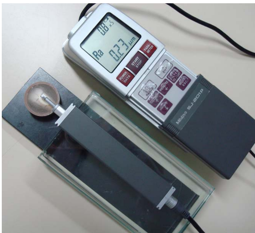
Figura 8 – Rugosímetro (Mitutoyo SJ-201P) do Laboratório de Ensaaios Mecânicos (UERJ) com o corpo de prova posicionado.
