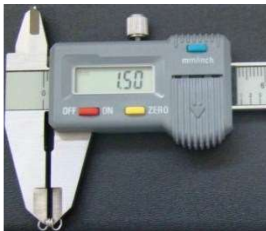
Figura 9 - Medição da largura da mola.
