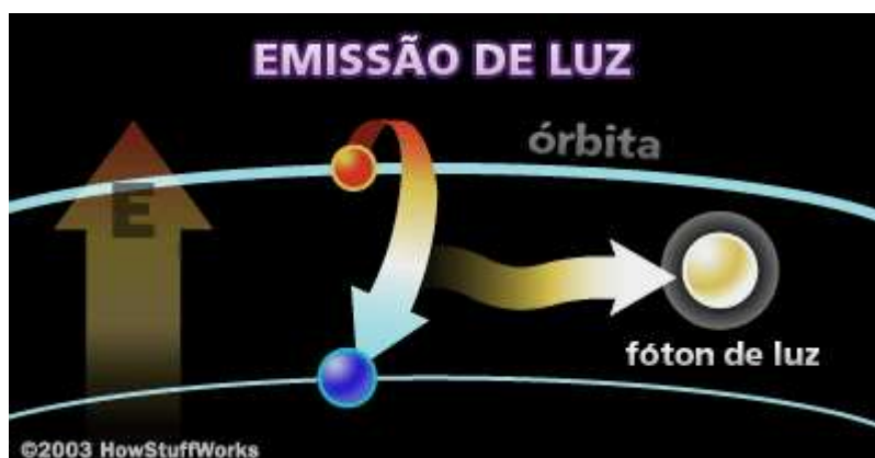
Figura 4 - Excitação dos átomos com liberação de um fóton.
