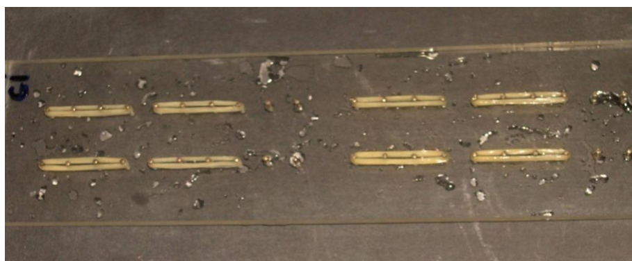
Figura 2 – Placa de acrílico contendo parafusos de aço inoxidável com os elásticos distendidos à distância de 30 mm
