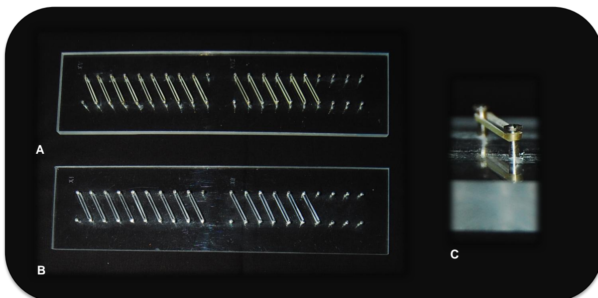
Figura 3 - Placas de acrílico com os elásticos distendidos a uma distância de 25mm
